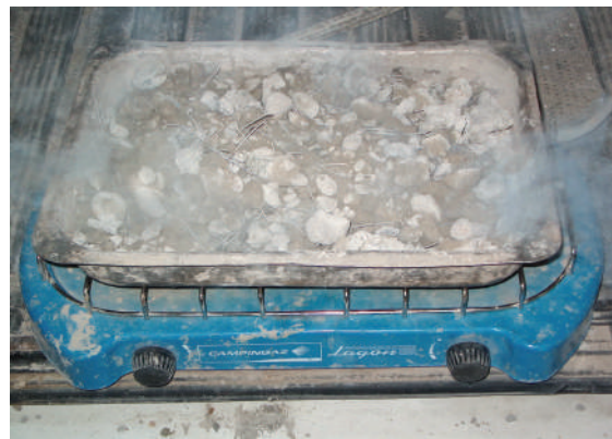
beton drogen in het werk
