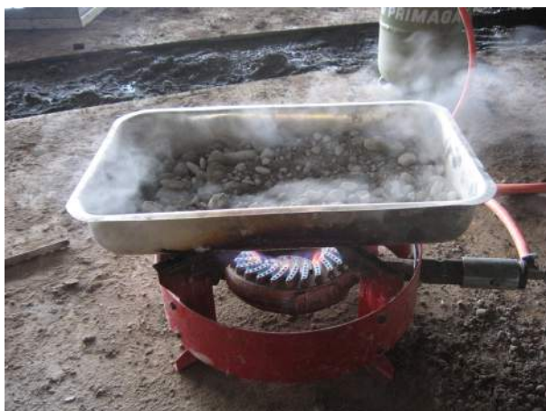
figuur 6: bepalen watergehalte op het werk
