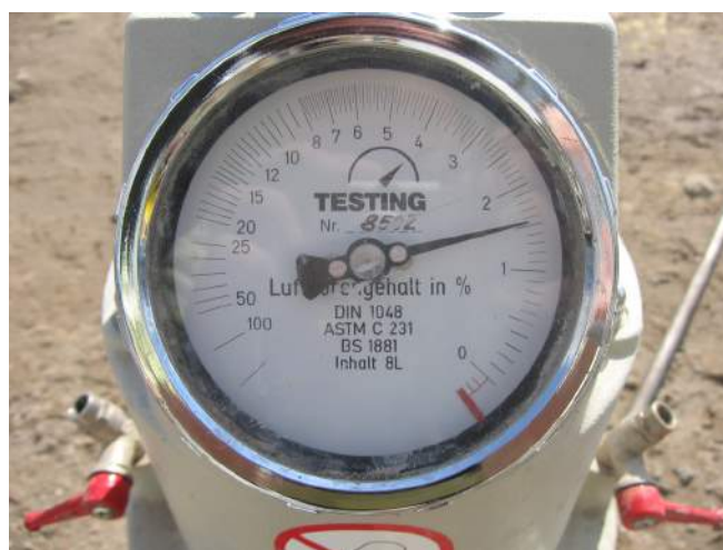
figuur 5: meting luchtgehalte
