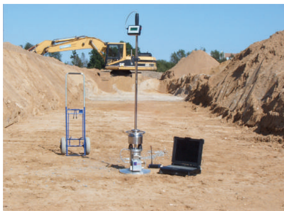
figuur 1: valgewichtdeflectiemeter 'Prima 100'
