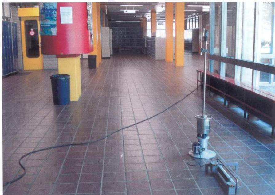
Een overzicht van een proeflocatie met valgewichtdeflectiemeting.
