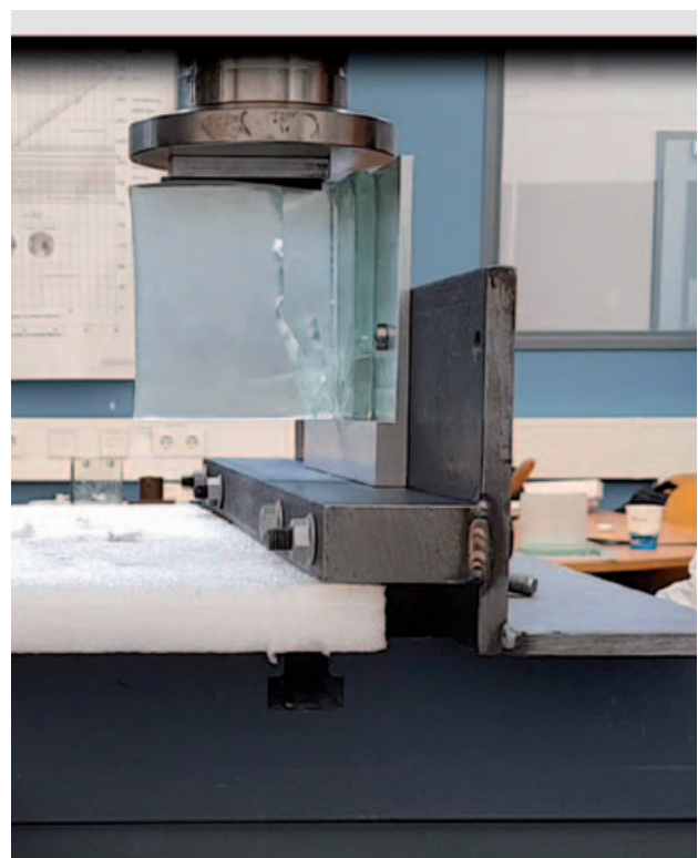
▲ Figuur 6: Het bezwijken van een gefuseerd proefstuk bij de afschuiftest.
