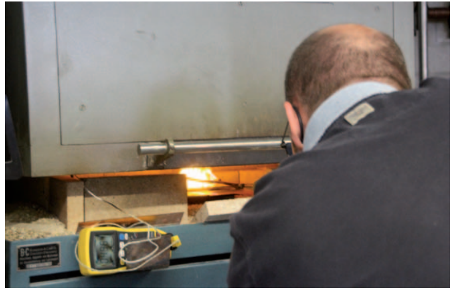
▲ Figuur 3: Het glas in de klokoven wordt met de lijnbranders lokaal en symmetrisch verhit.
